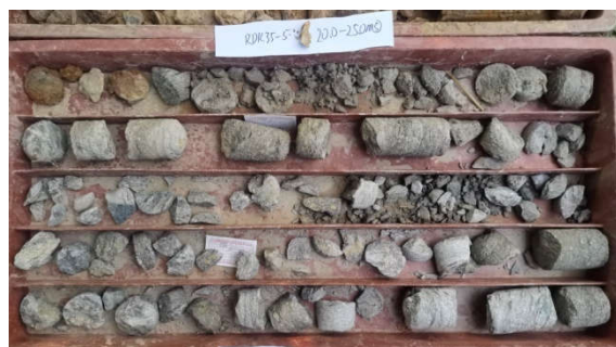
钻孔 RDK35（断层下盘断层破碎带及片麻 岩----孔深 20.0-25.0m）
