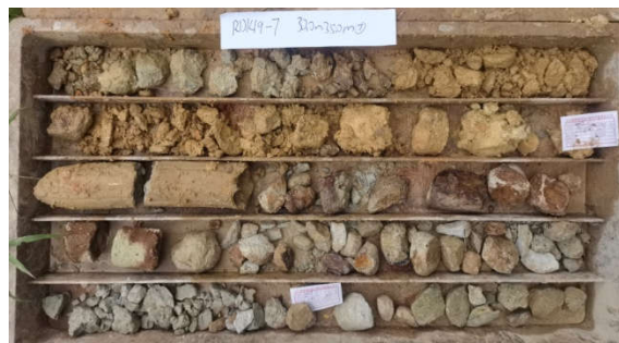
钻孔 RDK19（断层破碎带碎粒岩及断层泥-----孔深 30.0-35.0m）
