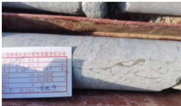
钻孔 RDK59（34.5 处）沿张节理充填黄铁矿
