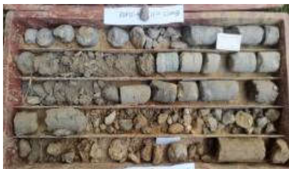
钻孔 RDK35（断层上盘页岩及断层破碎带---- 孔深 15.0-20.0m）
