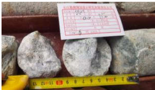
钻孔 RDK54（37.8m 处）可见长英质脉体充填
