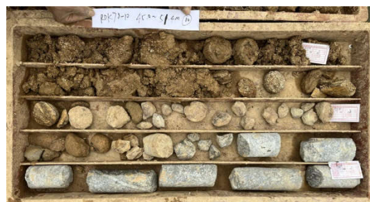
钻孔 RDK78（断层带全风化层界线陡降----- 孔深 45.0-50.0m）
