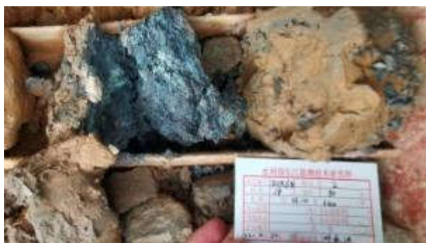
钻孔 RDK68（33.1m 处）全风化带可见原岩结构
