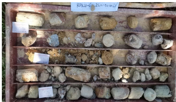
钻孔 RDK21（断层破碎带碎粒岩断层破碎带内局部可见断层泥-----孔深 25.0-30.0m）
