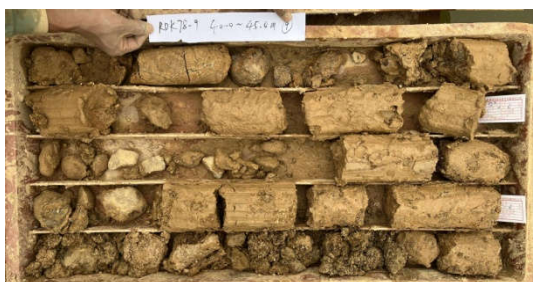
钻孔 RDK78（断层带全风化层界线陡降----- 孔深 40.0-45.0m）
