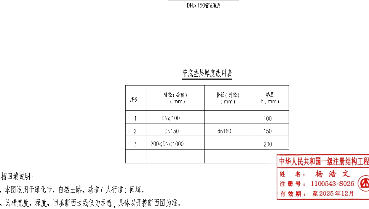
绿化带、自然土路回填做法2 DN \geq 150管道适用
