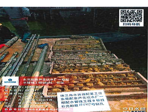
照片 17：BKDX17 号钻孔芯样
