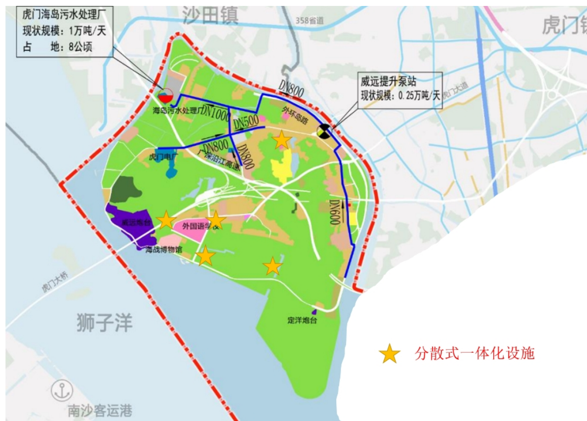
图 2.2-11 威远岛污水系统现状
