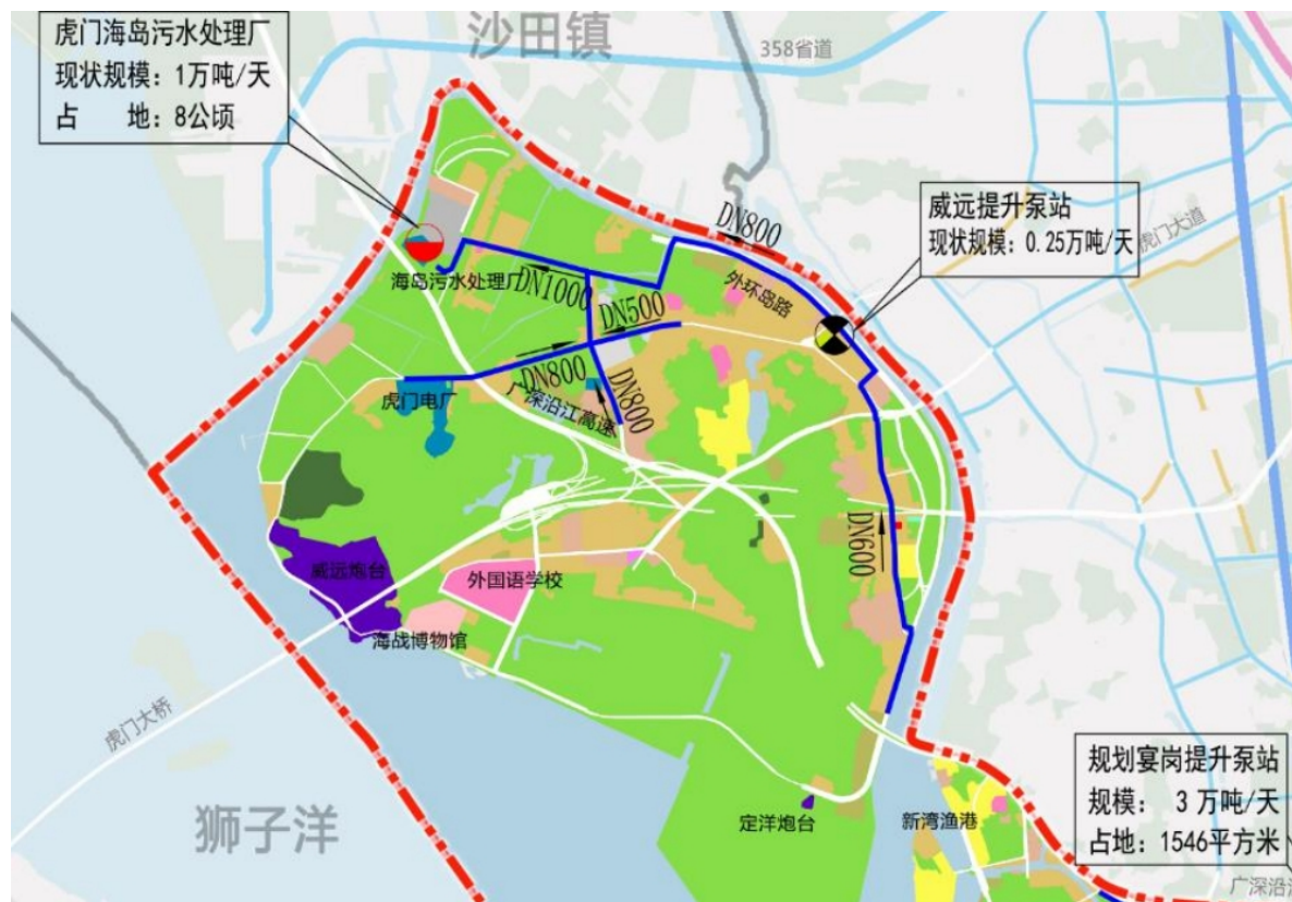
图 2.2-16 威远岛现状污水主干管
