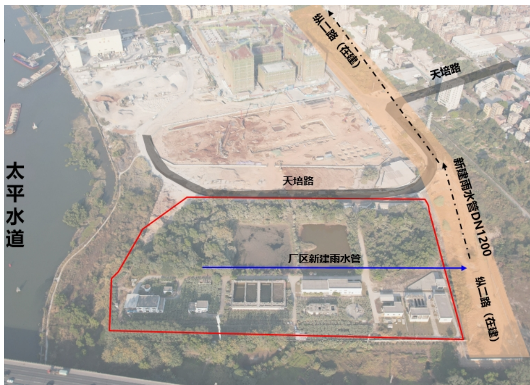
图 5.1-9 厂区雨水管道排放方式
