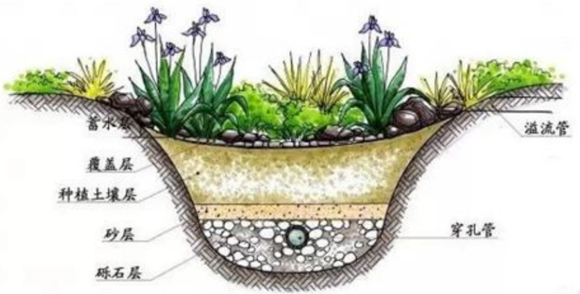
图 5.8-7 生物滞留设施示意图
