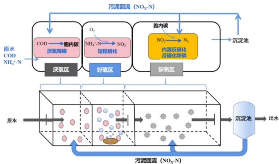
污水首先进入厌氧区，厌氧区污泥将外碳源转化为胞内碳源达到 COD 去除的目的，同时聚磷菌完成释磷反应。随后污水进入好氧区，聚磷菌在好条件下完成过量吸磷达到除磷目的，以及硝化菌完成硝化反应。最后进入缺氧区污泥 利用先前在厌氧区贮存内碳源以及回流污泥中 COD 作为额外碳源补充去除混合液中的硝态氮，从而完成脱氮作用。污泥回流至厌氧区为生化池提供污泥，另一污泥回流回流至缺氧区，由于回流污泥中含有的内碳源强化反硝化进行深度脱氮。该工艺通过排放剩余污泥从而完成除磷。
